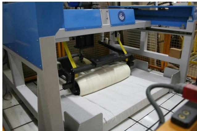
Figura 10 Ensayo normalizado de durabilidad de colchones.
